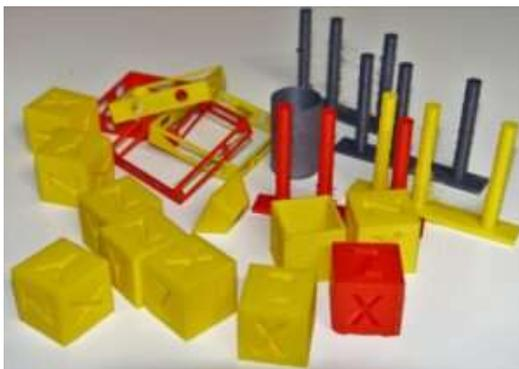
Ich hänge die Gcodes der unten gezeigten Drucke an. S3D schreibt zu Beginn alle Parameter als Kommentare in die Files. Bei den guten Drucken steht die Retraction Distance auf 3,5mm. Ein Wert, der für die Bowdenlänge nicht untypisch ist.
