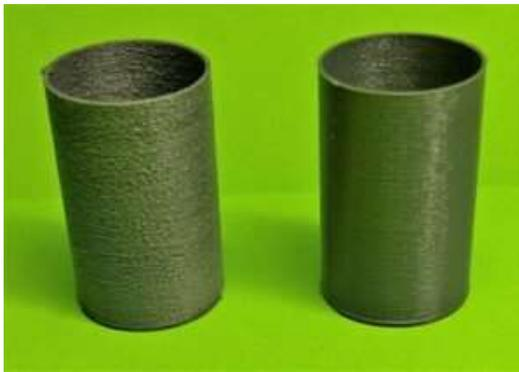
Es ist dasselbe Filament und derselbe Gcode. Links lag das Filament 4 Jahre rum, rechts nach 4h trocken in einem günstigen Dörrautomaten. Ein paar mehr Stunden hätten sicher auch noch mehr gebracht.
