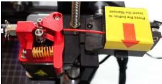
Ich hab das Filament 10 cm vor dem Sensor abgeschnitten. Das Ende läuft durch den Sensor und nichts passiert, auch nicht verzögert. Sobald das Ende die Transportritzel erreicht, drückt der Drucker in die Luft.
