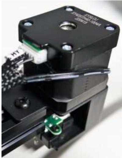
Die Riemenspanner liefern ein gutes Feedback, man merkt, ab welcher Position der Riemen unter Spannung kommt. Dann noch eine viertel bis halbe Umdrehung und gut. Genau so waren die Riemen ab Werk bereits eingestellt.
